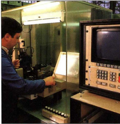
Qualitätssicherung: Daten aus modernen Mehrstellen-Messeinrichtungen werden in Computern abgespeichert, ausgewertet und dienen einer umfassenden Qualitätsüberwachung.
