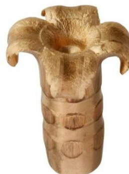
Das identische Geschoss nach dem Abfeuern - die Fahnen sind absolut symmetrisch und das Geschoss erzeugt mit ca. 99% Restmasse einen praktisch absolut geradlinigen Wundkanal. Hiermit wurden insbesondere auch die Belange von Chirurgen und röntgentechnische Aspekte adressiert um eine schnelle, effektive und humane Wundversorgung zu ermöglichen.
