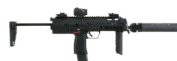
MP7 mit Schalldämpfer. Er verbirgt in der Regel die Mündungsflamme vollständig und erleichtert während des Einsatzes die Standortbestimmung und Kommunikation eigener Kräfte.
