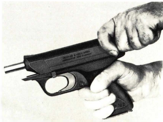
Fig. 4: Pull back the slide Retroceder la corredera Tirer le bloc-culasse vers l'arrière
