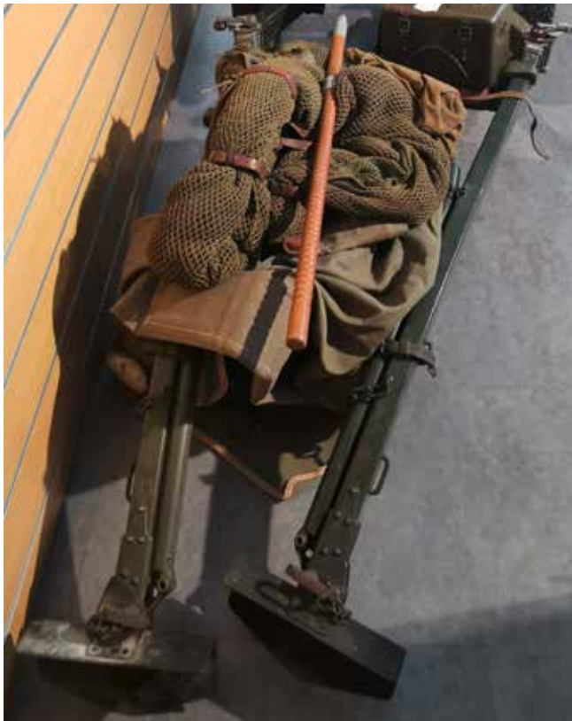
24613 CHF 2800.- 280089 Infanteriekanone IK 35/41, Kal. 4.7cm. Rohrrücklaufgeschütz, Lizenzfertigung nach Patent Böhler durch KW+Thun, Keilverschluss. Gabellafette mit zweiteiligem Schutzschild, Richtaufsatz Wild Heerbrugg mit Panoramafernrohr, Höhen- und Seitenrichtkreis. Das Geschütz ist sehr einfach zerlegbar und konnte auf 3 Pferde oder Maultiere gebastet werden. Dadurch war Transport und Einsatz bei der Gebirgsinfanterie möglich. Zubehör: Mündungskappe, Putzstock mit Wischer, kleines und grosses Tarnnetz, Verschlussabdeckung und Persenning aus Leinen. Blechbox zur Aufbewahrung des Richtaufsatzes und diverse Ersatzteile. Munitionsköfferchen aus Stahlblech, enthaltend 1 Manipuliergranate mit integriertem Markierpatronenlager für blinde GP11, 1 inerte Panzergranate mit Bodenzünder, 1 inerte Übungspanzergranate, 2 leere Messinghülsen. #1207 Zustand 1
