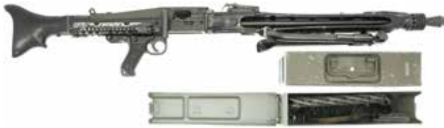
44234 CHF 1500.- 243908 Maschinengewehr, MG42, Gehäuse «ar» für Mauser Werke. WaA arz, Kal. 8x57IS. LL 560 mm, TL 1210 mm. Semi-Auto-Änderung nach alter Schweizer Norm. Gehäuse und Mantelrohr aus gepresstem Stahlblech, schwarz lackiert, Verschlusskastendeckel phosphatiert. Rückstosslader mit Rollenverschluss. Leitkurvenvisier, einstellbar bis 2000 m. Kolben und Griffschalen aus Bakelit. Zweibeinstütze aus gepresstem Stahlblech, 2 Gurtenkisten mit Gurten. #4493c Zustand 2
