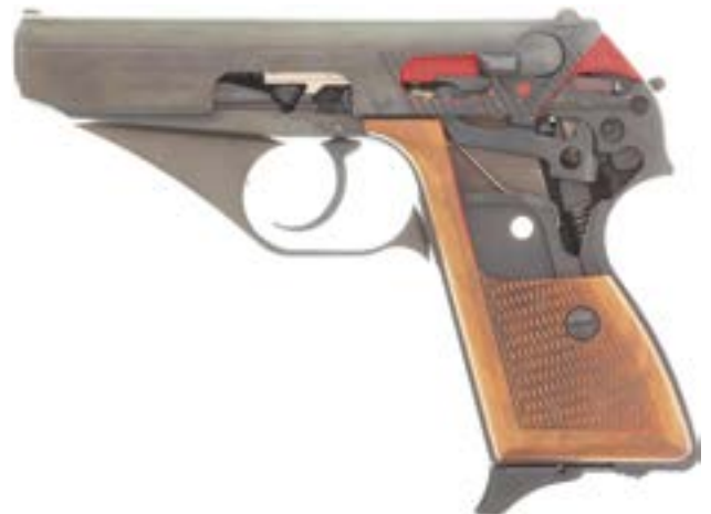
39494 CHF 550.- 235289 Werksschnittmodell Mauser HSc Kal. (7.65mmBr) aufgeschnitten. Spannabzugspistole mit aussenliegendem Hahn und Sicherungs/Entspannhebel auf der linken Schlittenseite. Hochglanzpolierte, brünierte Fertigung, links am Schlitten Mauser-Schriftzug, Holzgriffschalen mit Fischhaut. Schlitten und Griff sind zur Demonstration der Funktion aufgeschnitten, die Schnittflächen sind mit roter Farbe ausgelegt. Ohne Nummer Zustand neu
