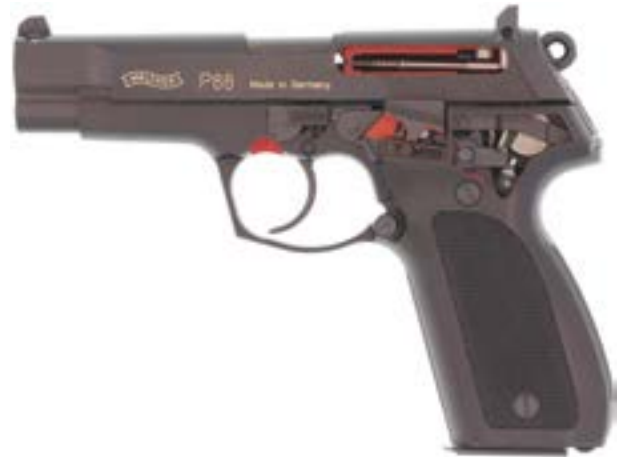
39493 CHF 550.- 235353 Schnittmodell Walther P88, Kal. (9mmPara) aufgeschnitten. Zur Veranschaulichung der Funktion aufgeschnitten, die Schnittkanten sind mit roter Farbe ausgelegt. Das Griffstück aus Alu ist schwarz eloxiert, Lauf, Schlitten und Bedienteile sind matt brüniert. 1 vernickelte Manipulierpatrone. #ohne Zustand neu
