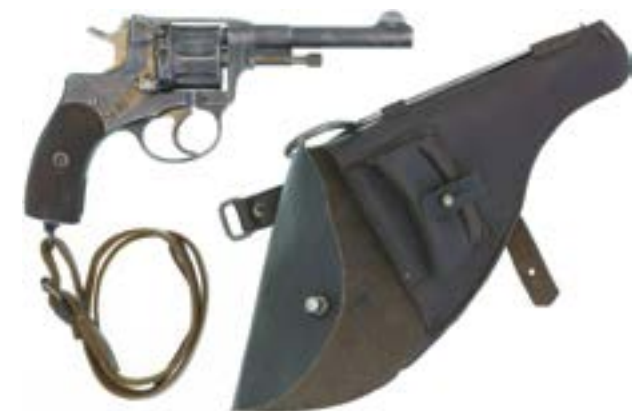
46836 CHF 280.- 251917 Revolver, Nagant Mod.1895, Mannschaftswaffe, Kal. 7.62mmNag. LL 115 mm, 7-schüssiger, gasdichter SA-Revolver der russischen Armee. Brünierte Ganzstahlwaffe, Rundlauf, Kimme im Rahmen integriert, Dachkorn. Bedienelemente gelb angelassen. Dreiteilige Holzgriffschalen mit Fischhautverschnitt, Fangschnurring mit ledernem Fangriemen. Lederfutteral, Putzstock. Hergestellt wurde die Waffe 1912, rechts am Ramen Zarenadler. # 30388 WES Zustand 2
