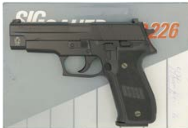
46961 CHF 500.- 251848 Pistole, SIG-Sauer P226, Polizei Genf, Kal. 9 mmP. LL 108 mm, schwarz eloxiertes Leichtmetallgriffstück, Schlitten Stahl, schwarze Ilaflonbeschichtung. DA-Abzug mit Abspannhebel, Kimme und Korn seitlich eingeschlaucht. Schlitten vorne links Genfer Wappen in Lasergravur. DE- und CH-Beschuss, schwarze aufgerauhte Kunststoffgriffschalen mit Firmenlogo, Originalschachtel. # U619365 WES Zustand neuwertig
