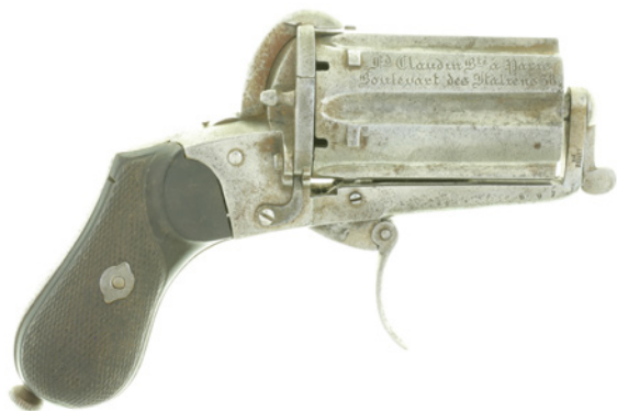
64055 CHF 220.- 286508 Pepperbox, Deprez Liège, Kal. 9mmLefauchaux. Sechsschüssige Trommel mit eingravierter Händleradresse: „Fd. Claudin Bte a Paris Boulevard des Italiens 38.“. DAO-Schloss mit Klappabzug, der Rahmen rechts vorne gestempelt: „Deprez Bte“ (Deprez Jean Mathieu, 1857-1863). Ebenholzgriffschalen mit Fischhautverschnitt, an der Griffunterseite heraus-schraubbarer Ausstosserstift. #7 ANT Zustand 2
