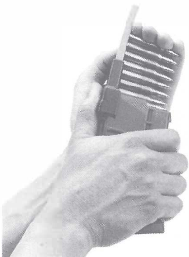
Einfüllen der Patronen mit Hilfe des Ladeaufsatzes
